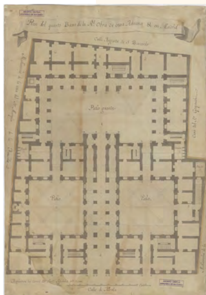
Plano de la planta baja de la Real Casa de Aduana. Arquitectura de Francisco Sabatini (1769).
